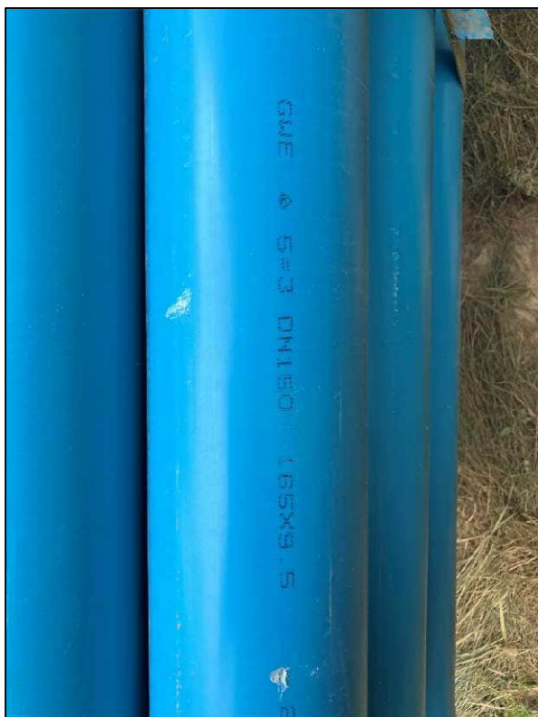
Obr. č. 5: Výstroj 165/9,5 mm – detail
